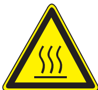
Warnung vor heißer Oberfläche
